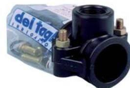
Prese a staffa rapide per il collegamento degli irrigatori alle tubazioni, compatibili con i giunti flessibili, le prolunghe estensibili TH ed a segmenti CR. I bulloni con testa incassata facilitano il bloccaggio sul tubo. Corpo in polipropilene, pressione massima d'esercizio 8 BAR, confezionate in sacchetti singoli.
