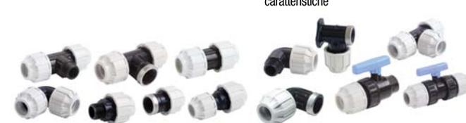
Disponibili da 1/2" a 2" sono dotati di guarnizioni per poter garantire la tenuta idraulica, fino a 10 Bar, anche senza l'utilizzazione di nastro per giunzioni. Possono essere avvitati senza l'uso di attrezzi con grande risparmio di tempo. Il polipropilene assicura la massima robustezza ed inalterabilità nel tempo ed offre la migliore compatibilità con gli altri materiali dell'impianto. Pressione massima di esercizio 16 bar.
