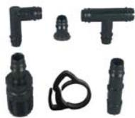
Raccordi portagomma per tubo da 16 mm. Si consiglia l'uso dell'anello stringitubo CLIP-12 (per tubo poroso Poritex) o CLIP-16 (per ala gocciolante o tubo 16 mm) con pressioni di esercizio superiori a 1,5 Bar.
